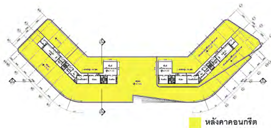
ภาพที่ 4 – พื้นที่ที่นำมาคำนวณ RTTV และวัสดุหลังคาของส่วนสำนักงาน
